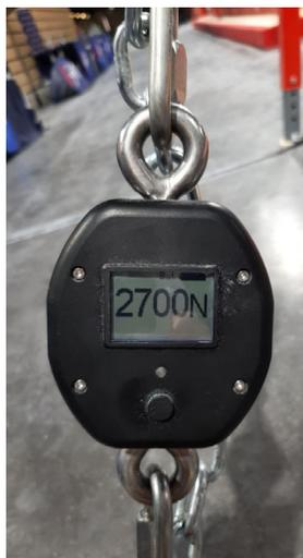
De utilización sencilla gracias a su tecla para tomar medición y a su pantalla digital, este tensiómetro **permitirá a los gimnastas adaptar la tensión de los cables de sus aparatos en función de sus necesidades** tan en competición como al entrenamiento.
