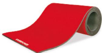
El confort viene de la mano de las pistas enrollables de 38 mm de espesor constituida de una moqueta flameada sobre una espuma dinámica de alto rendimiento. Una red colocada entre la moqueta y la espuma permite aumentar la resistencia al punzamiento y la estabilidad dimensional. Con el fin de garantizar una armonización perfecta, las
